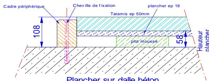
Plancher sur dalle béton
