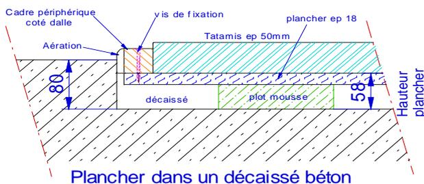
Plancher dans un décaissé béton
