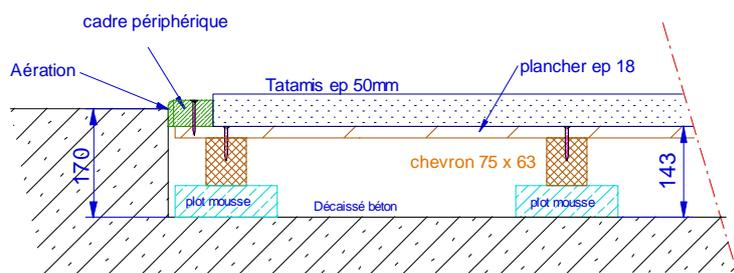
Plancher dans un décaissé béton
